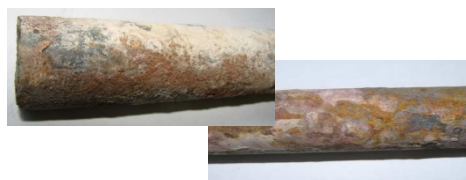
Porównanie grubości powłoki ochronnej przed i po testach
