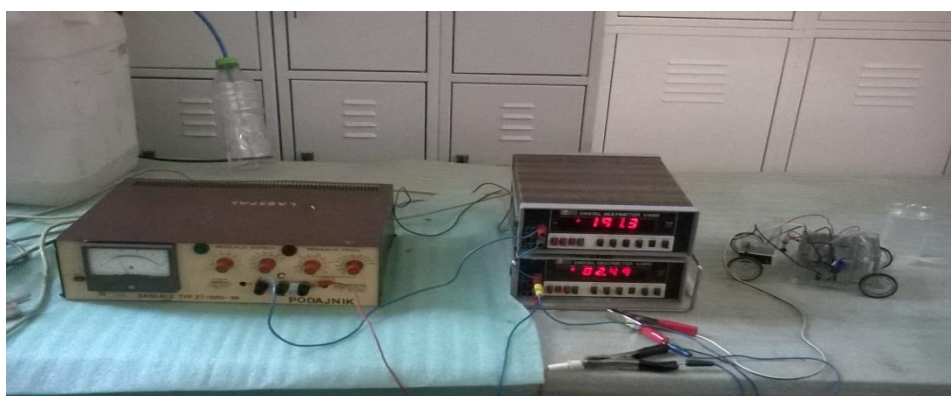
Rys.4. Stanowisko badawcze- mini-pojazd, zasilacz, mierniki napięcia i natężenia.
