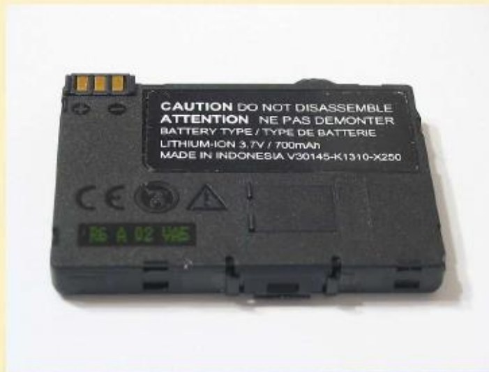
Akumulator Li-ion 3,7V/700mAh do telefonu komórkowego
